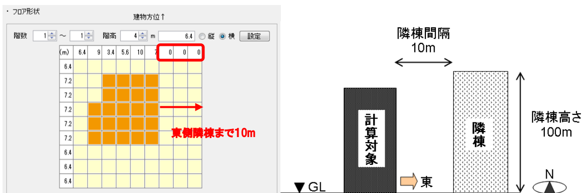
図 1.3.1.4 隣棟の入力事例
