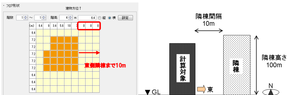
図 1.3.1.4 隣棟の入力事例
