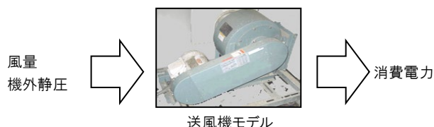
図 2.4.5-6 送風機モデルの入出力
