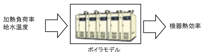
図 2.4.2.3-1 真空温水器モデルの入出力
