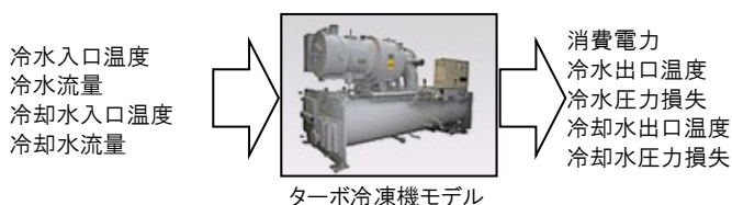
図 2.4.2.1-1 ターボ冷凍機モデルの入出力
