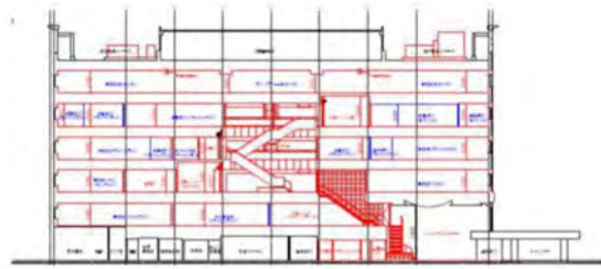
断面図(赤の部分を改修)
