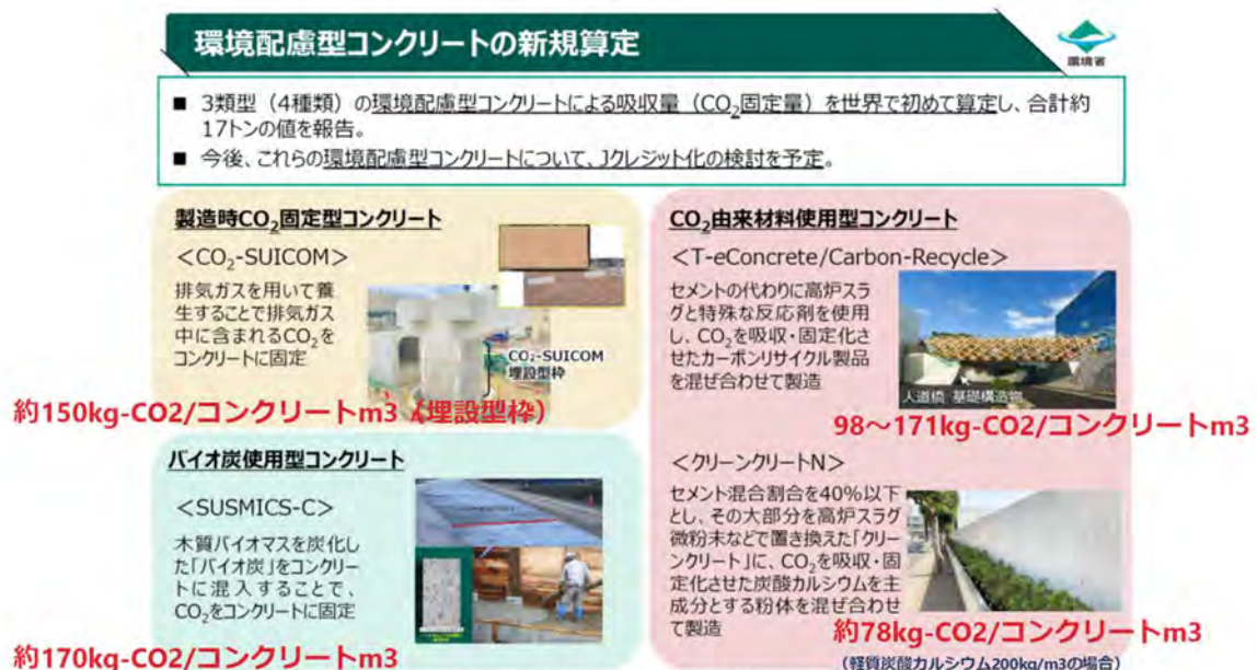
図 3-2-42. 環境配慮型コンクリートの CO 2 固定量（暫定）
