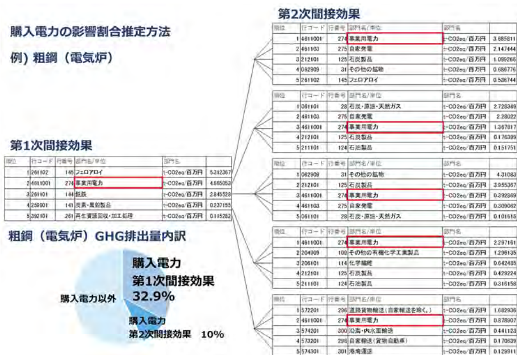
10 図 3-2-36. 購入電力の影響割合推定方法（粗鋼（電気炉）の例）
